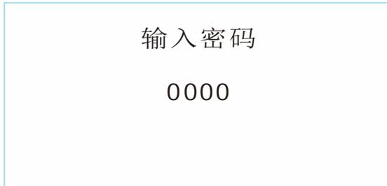
用户如果要查看记录、设置参数、进入检修模式时，按“设置键”弹出密码输入界面，通过“上下键”和“左移键”可以修改密码，输入密码后按“设置键”确定，如果密码正确则进入参数设置界面，如果密码不正确则显示“密码错误”提示用户修改，在密码输入界面按“取消键”返回到监控状态。
