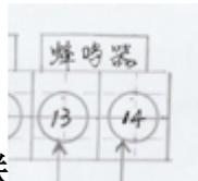
常用外送信号建议，直接并联 端口（13 14 号喇叭端口，左正右负），即可。
