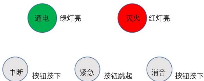
3. 设备手动灭火：当灶台起火时，按下紧急按钮，即可立即启动灭火火，设备灭火灯及报警同时触发。如下图
