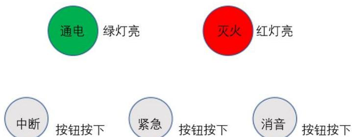
4. 防勿喷/防误启动功能：当设备进入灭火程序时，在警报响起，灭火灯未亮的数秒内可按中断按钮中断灭火程序。避免设备材料不必要的损耗。如下图
