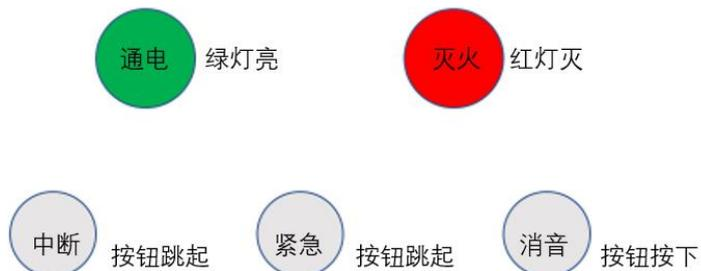
**5 设备消音：**当设备进入灭火程序时，警报响起，为避免干扰，可于此时按一下消音按钮消音。待灭火结束后，再次按压消音按钮，确保灭火程序启动时，能及时报警。消音状态时，如下图
