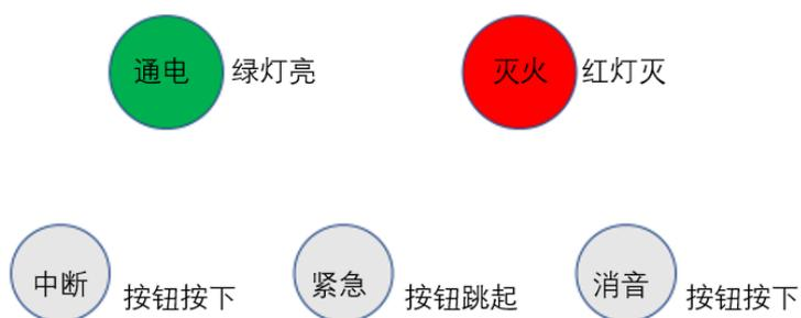
2. **设备自动灭火**：当灶台起火时，**警报响起**，数秒后**灭火灯亮起**，设备自动开始灭火。如下图
